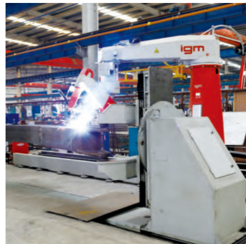
焊接机器人 Welding robot
